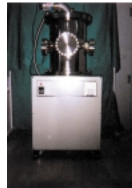
超高真空を活用した有機薄膜作成システムの真空チェンバー部
