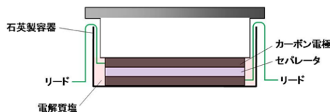
▲熱起動型溶融塩キャパシタ試作セルの模式図と外観
