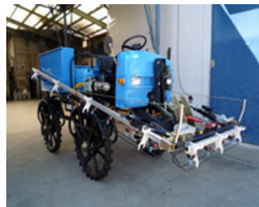
▲ 静電防除ブーム装置を 取り付けた多目的農作業車
