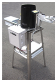
▲ 病害感染・生育予測機能を備えた作物の栽培支援装置
