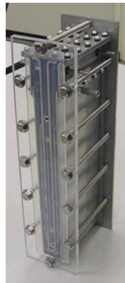
図：高分子固体電解質膜を使用した浄水装置
