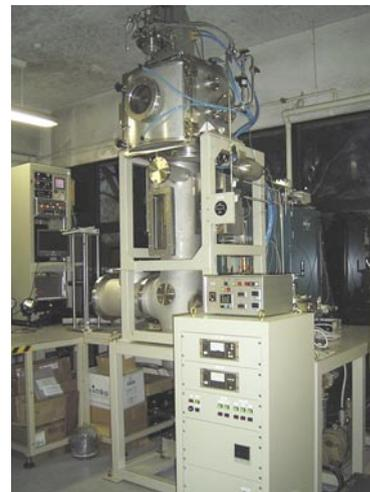
高結晶性半導体マイクロ粒子製造装置
