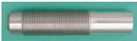
次世代超高温ボルト鋼材
