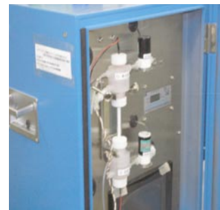
NOx自動連続測定装置
