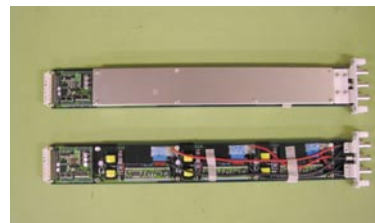
高圧電源ユニット 1チャンネルあたりの概観
