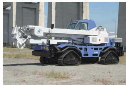
車軸装着状態のクローラユニット
