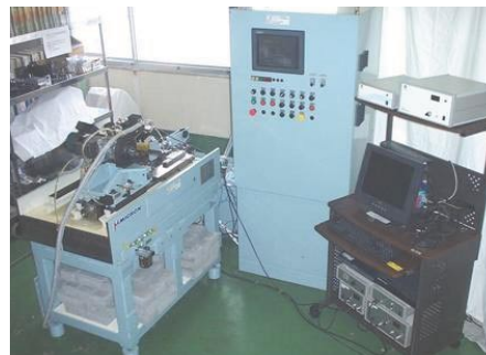
圧電アクチュエータによる負荷補償型 精密センタレスグラインダー式
