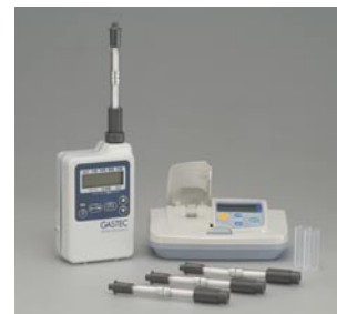
有害ガスモニタリング装置一式
