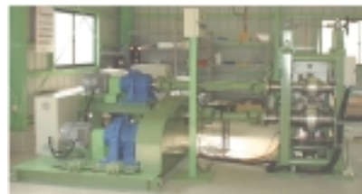
図1：ニアネット・シェイプ 急凝固連続鋳造装置
