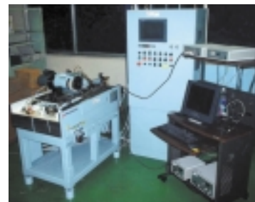
圧電アクチュエータによる負荷補償型精密センタレスグラインダ
