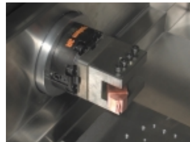
銅電極加工テスト外観
