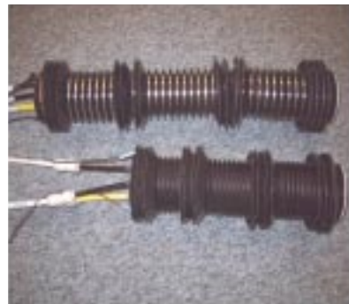
▲自走検査装置（上：芯金一体型 下：従来型）
