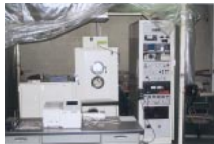
▲バッチ式イオンプレーティング 装置
