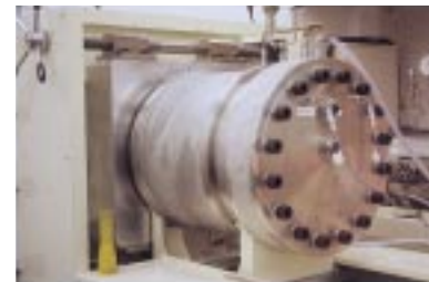
燃焼合成による金属間化合物の実生産用システム
