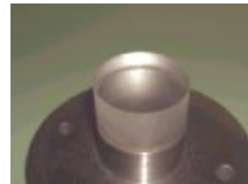
直径 40mm のガラス素 材の球面加工例
