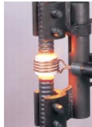
▲加熱コイルの接続状態
