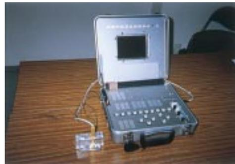
試作さび安定度測定装置
