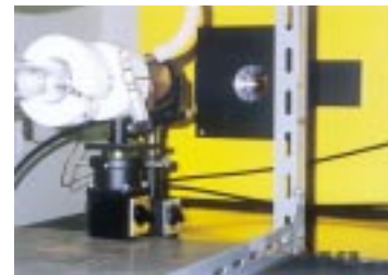
CO 2 レーザーによる 酸素 18 濃縮実験
