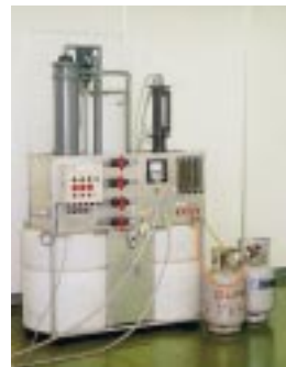
代替フロン・ フロン破壊装置
