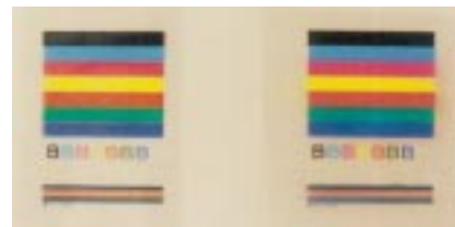
インク受容層の耐水性 左：未浸漬 右：14日浸漬後
