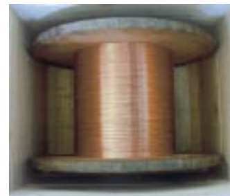
試作した 500m 級 Nb 3 Sn 超電導線
