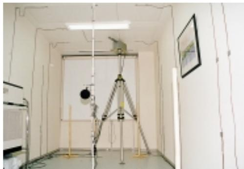
輻射冷暖房システムの性能測定
