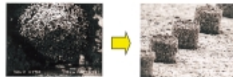
印刷状態 (印刷マスクの開口穴寸法 65 \mu m 厚み : 50 ミクロン)
