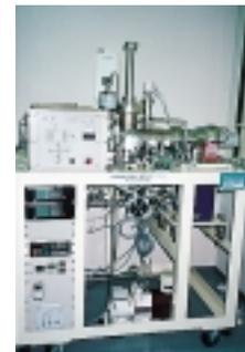
極細微細孔構造の精密決定システム
