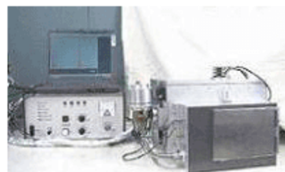
多重励起源を有する□線管球を用いた分析装置 広範囲の元素を高感度で効率よく測定することができる卓上型全反射蛍光X線分析装置。大学発ベンチャーを起業。
