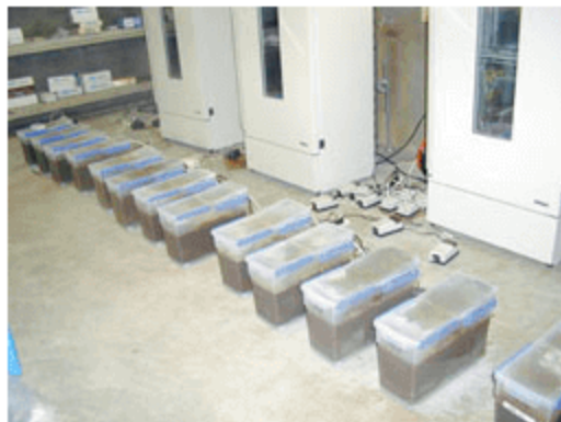
し尿のばっ気処理実験装置
