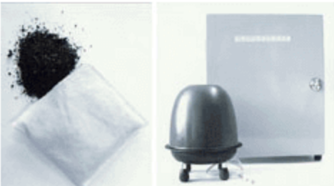
試剤担持粉炭、粉炭入袋と、それを装填した試作消臭装置
