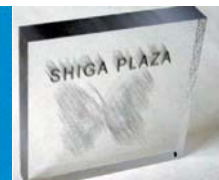
CO 2 /N 2 含浸プラスチック材料へのレーザー印字例
