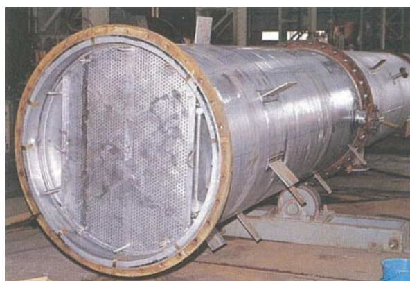
高クロム超耐食鋼を用いた熱交換器
