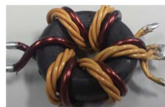
試作したリーケージトランスの外観 鉄心サイズ： \Phi 2.5\text{ cm} \times h 0.7\text{ cm}
