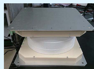
電気自動車給電用磁性めっき 試作コイル
