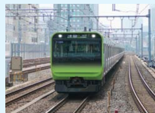
～SiC採用のE235系～ 鉄道車両への試験搭載から実用化へ
