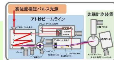
先端計測機器のプロトタイプ機 (イメージ)
