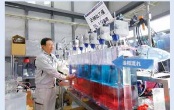
10リットル/段の実証装置（正抽出工程6段+逆抽出工程2段）を使いLIBリサイクルでのコバルト/ニッケル分離実験を行う永野氏
