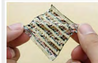
図1 厚さ0.003mmの有機太陽電池
