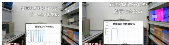
ビーコンを用いたトラッキング給電
