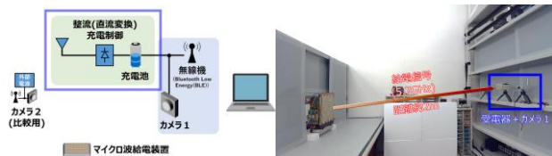
2m離れた無線カメラへ給電
