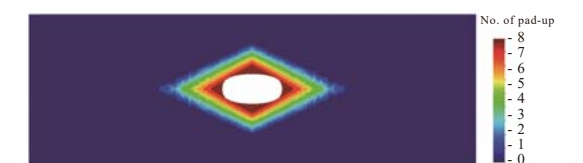
(b) Pad-up形状最適化結果
