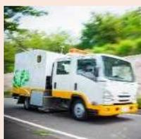
国民会議による技術マッチングにより、地中レーダーと全周囲カメラを用いた地下と地上の全方位3次元マッピング技術の現場試行を行い、実用化(東京都足立区)
