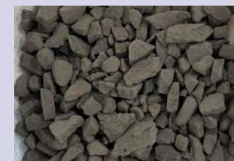
アンモニアを酸化し改質触媒に熱を供給する触媒
