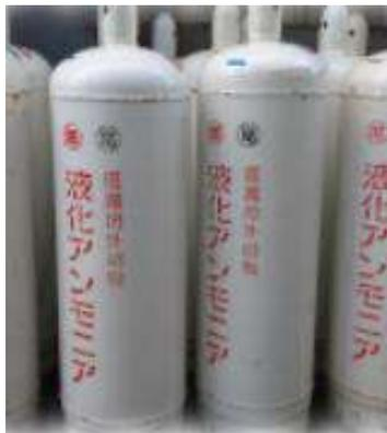
液化アンモニア50kgボンベの外観（140kWh発電可能、LPGボンベとほぼ同じ）
