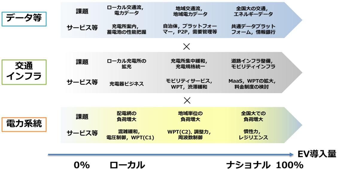
図 5-14 EVの導入量とVGI(Vehicle Grid Integration)サービスのイメージ
