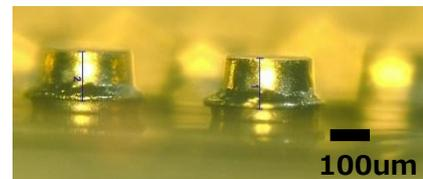
WBGデバイスとソース、ゲート側銅回路パターンとをCuバンプにて接続し、小型デバイス対応・低L化
