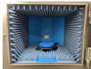
電波暗箱による測定
