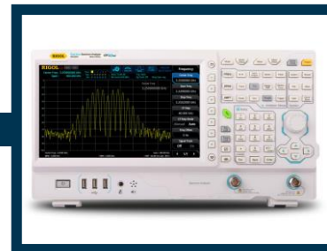
スペクトラムアナライザ 最大許容電力 =30dBm (=1W)
