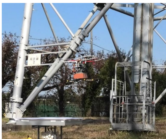
(b) 変電所巡視の模擬試験
