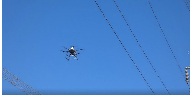
(b) 送電線巡視の模擬試験
