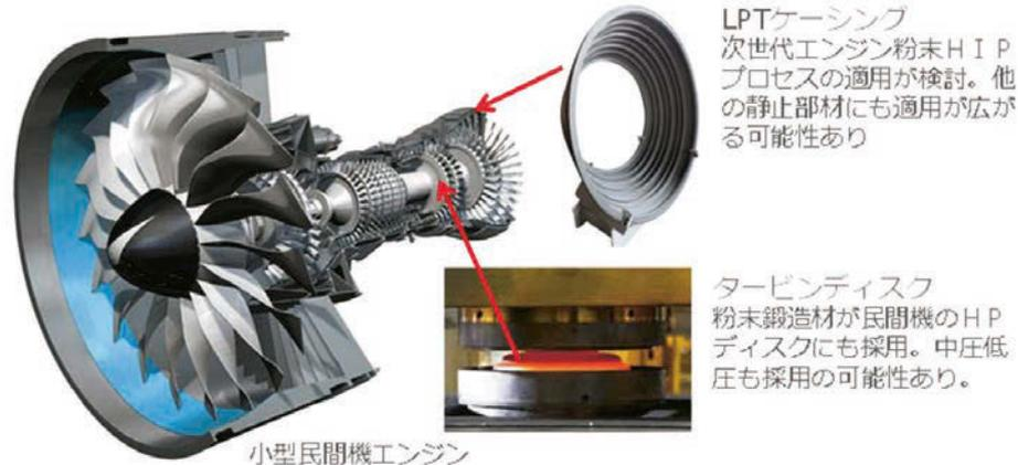
図 C2-1-(1) 民間航空機エンジンに用いられる粉末プロセス材の例
