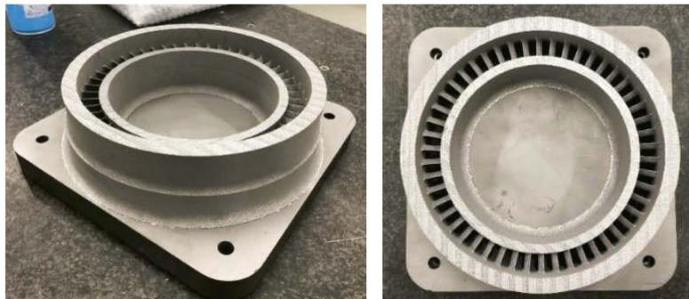
図 C3-(4) Concept Laser M2（第 4 世代）を用いて造形した模擬ノズル
