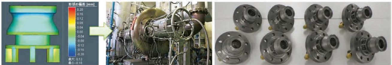
図 C1-(5) 燃焼試験に供した 3D 積層造形プロセス製 燃焼バーナ
