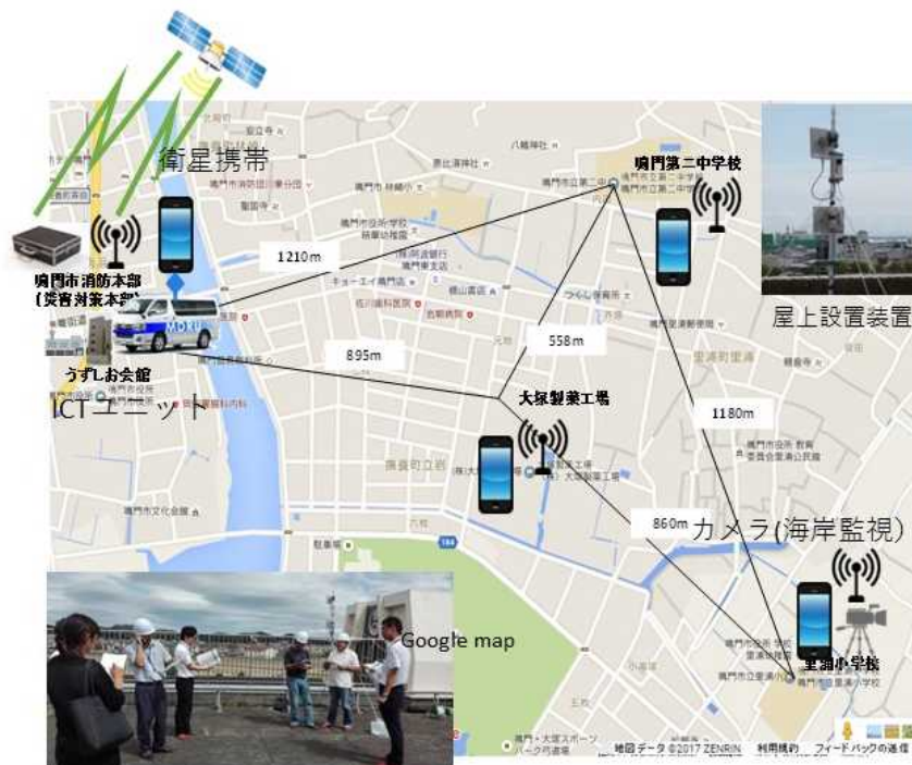
図：応急ネットワークによる非常時情報伝達実験実施例（徳島県鳴門市）
