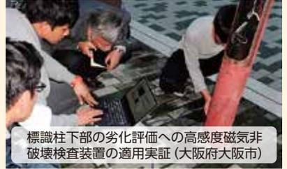
標識柱下部の劣化評価への高感度磁気非破壊検査装置の適用実証（大阪府大阪市）
