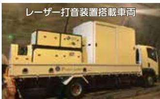
レーザー打音装置搭載車両
