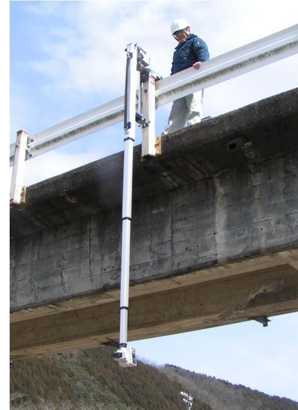
橋梁点検ロボットカメラ
