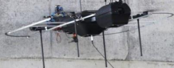
① 打音機能付飛行ロボット
